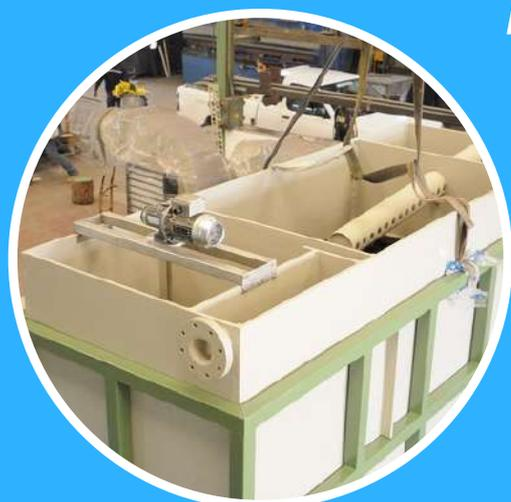
La decantación es una actividad necesaria para eliminar los sólidos sedimentables. La mayor parte de las sustancias en suspensión en las aguas residuales industriales no pueden retenerse con otros equipos de pretratamiento como rejillas, desarenadores, separadores de grasas, ni equipos de flotación, por su densidad y tamaño.
