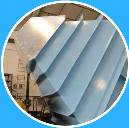
La función del Decantador Lamelar es poder separar los elementos semipesados y pesados en suspensión, que llevan las aguas residuales industriales y que perjudican el tratamiento posterior, generando depósitos en las conducciones hidráulicas, tuberías y canales, así como abrasión en rodetes de bombas y otros equipos.
